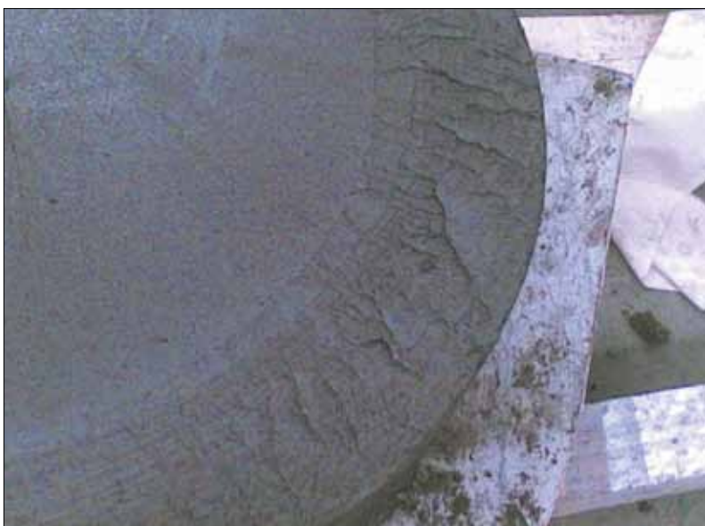
Рис. 5 Вид излома (фронт круговой трещины)
