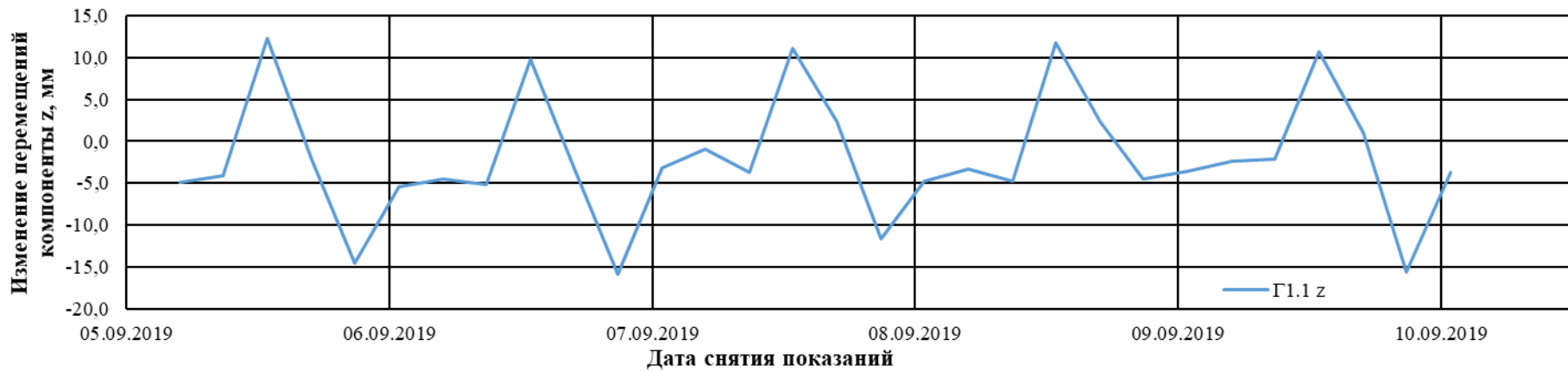
Рисунок 4.10 – Вертикальные перемещения точки мониторинга 1.1 за пятидневный интервал в сентябре 2019 г.
