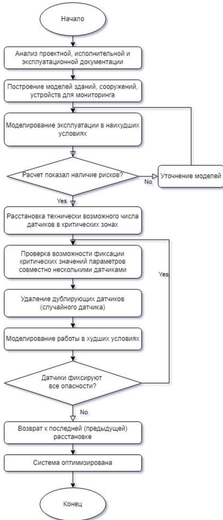
Рисунок 4.2 – Алгоритм методики обоснования количества и расположения измерительных датчиков
