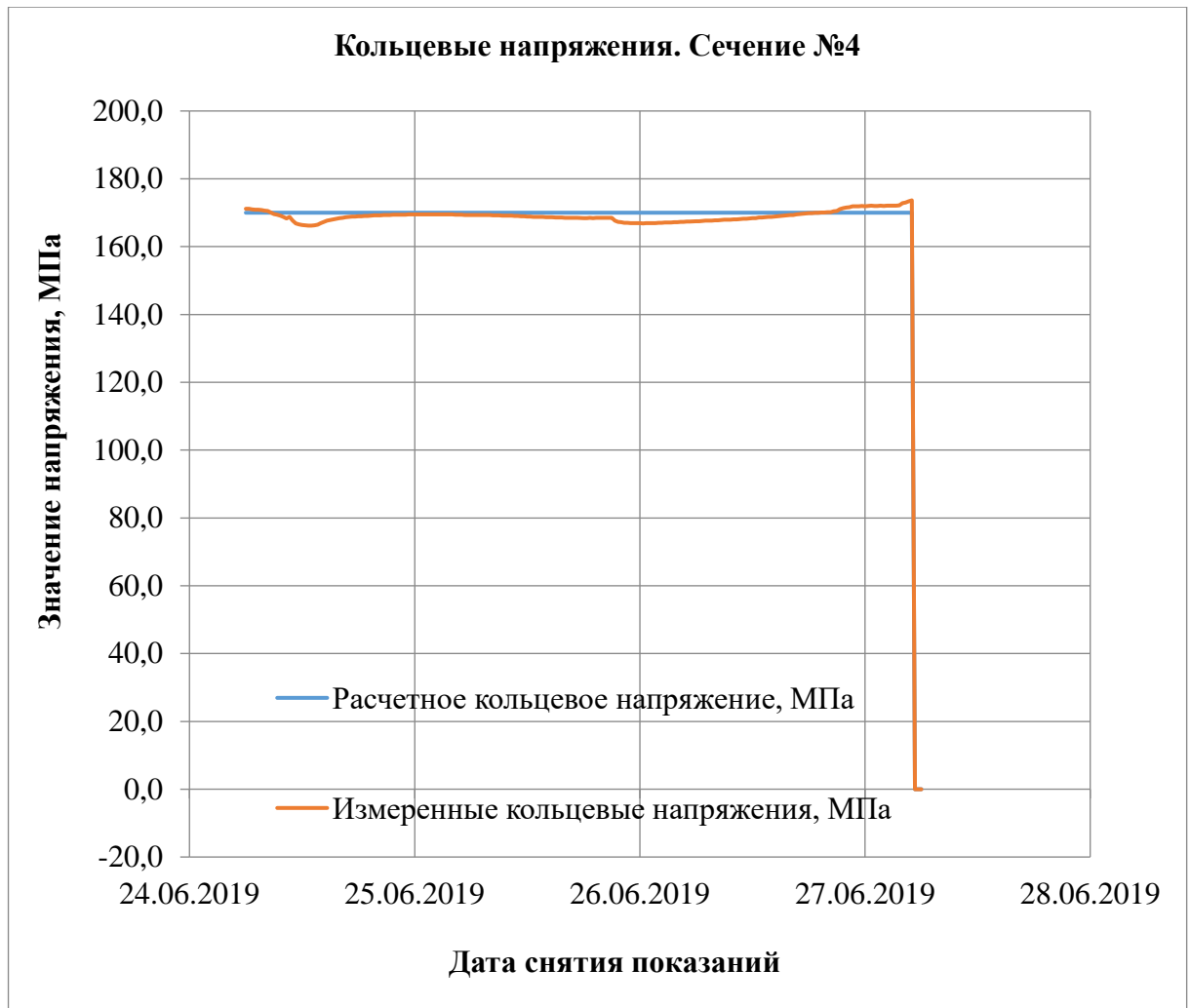
Рисунок 4.4 – Расчетный и измеренный графики изменения кольцевых напряжений в период с 24.06 по 28.06.2019
