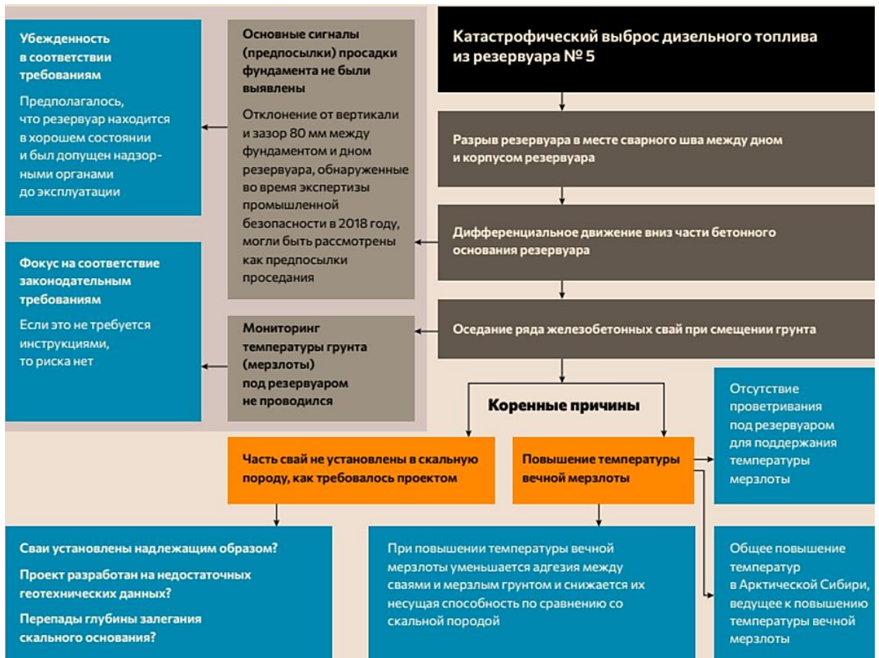
Рисунок 4.24 – Резюме анализа корневых причин разрушения резервуара на ТЭЦ-3 АО «НТЭК» [138]
