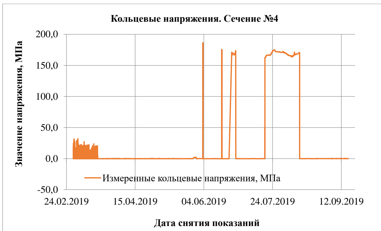
Рисунок 4.5 – График изменения кольцевых напряжений по показаниям системы мониторинга в период с 01.03 по 16.09.2019
