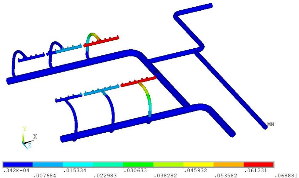
Рисунок 2.10 – Суммарные перемещения моделируемого участка технологических трубопроводов, м
