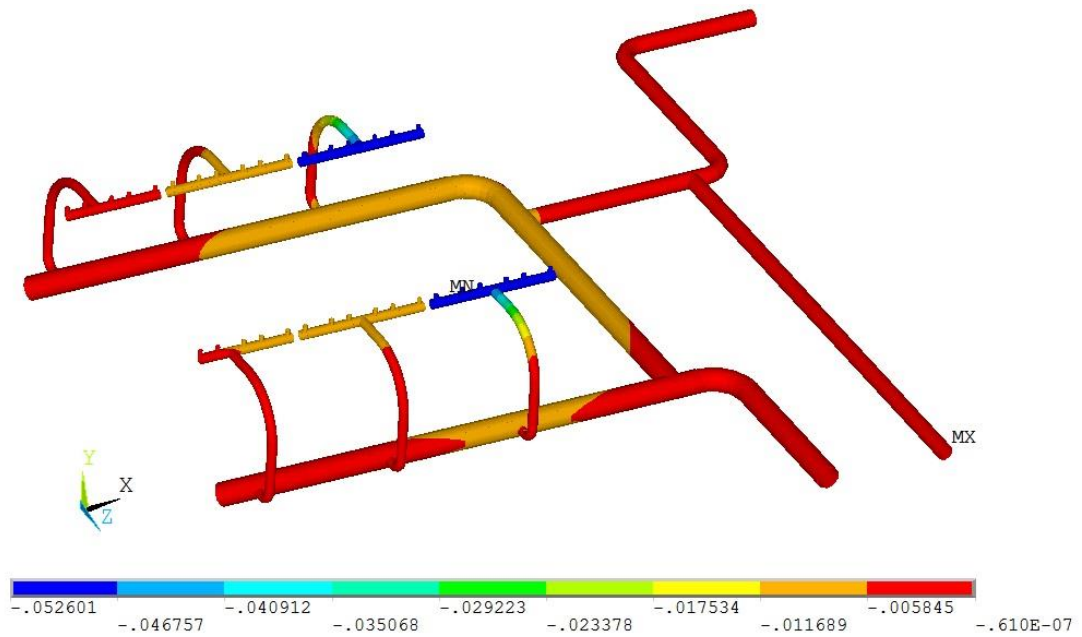
Рисунок 2.11 – Вертикальные перемещения моделируемого участка технологических трубопроводов, м
