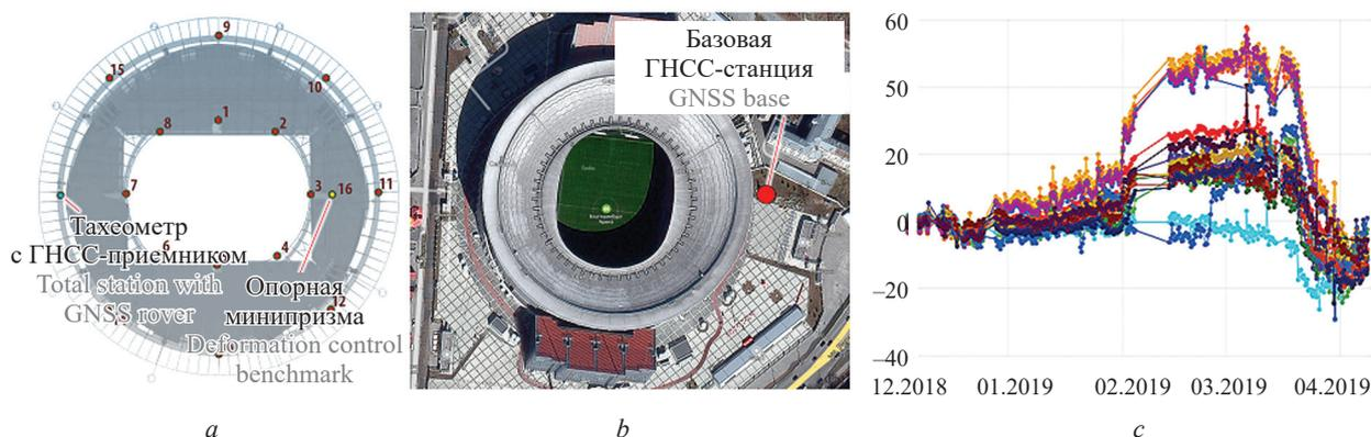
Рис. 9. Схема расположения оборудования системы геодезического мониторинга: *a* — деформационных марок № 1–15 и роботизированного тахеометра на конструкциях покрытия, опорной марки № 16 на конструкциях трибун; *b* — базовой ГНСС-станции на прилегающей территории; *c* — результаты мониторинга вертикальных перемещений деформационных марок с 12.2018 по 04.2019, мм
